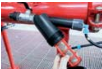
Fotografía 1.6: Filtros de malla. (Foto: Sistema AZUD, SA.)
