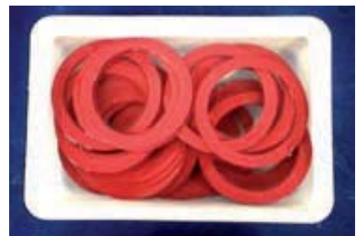
Fotografía 3.3: Colocación de anillas en ácido para una limpieza en profundidad.
