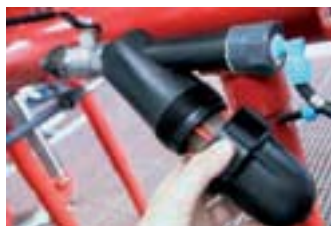
Fotografía 1.6: Filtros de malla. (Foto: Sistema AZUD, SA.)
