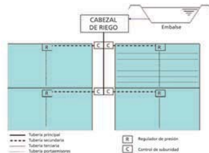
Figura 1.1: Esquema tipo de una instalación de riego por goteo (embalse-cabezal-red distribución-parcelas de riego).
